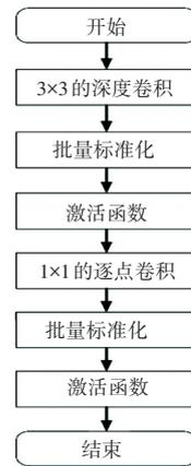
图 1 深度可分离卷积操作流程图
