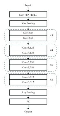
图 1 ResNet34 结构图
