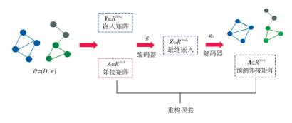
图 5 图自动编码器模型结构
