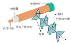
图 3 漏波电缆结构图
